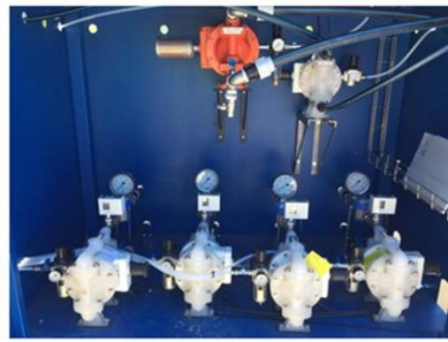
Detalle de las bombas de inyección
