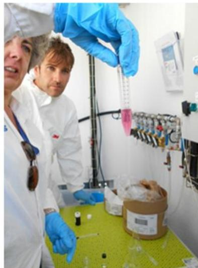
Determinación de la concentración de persulfato en una muestra de agua mediante kit in situ
