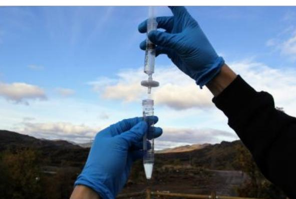
Field kit test B para la determinación *in situ* de persulfato
